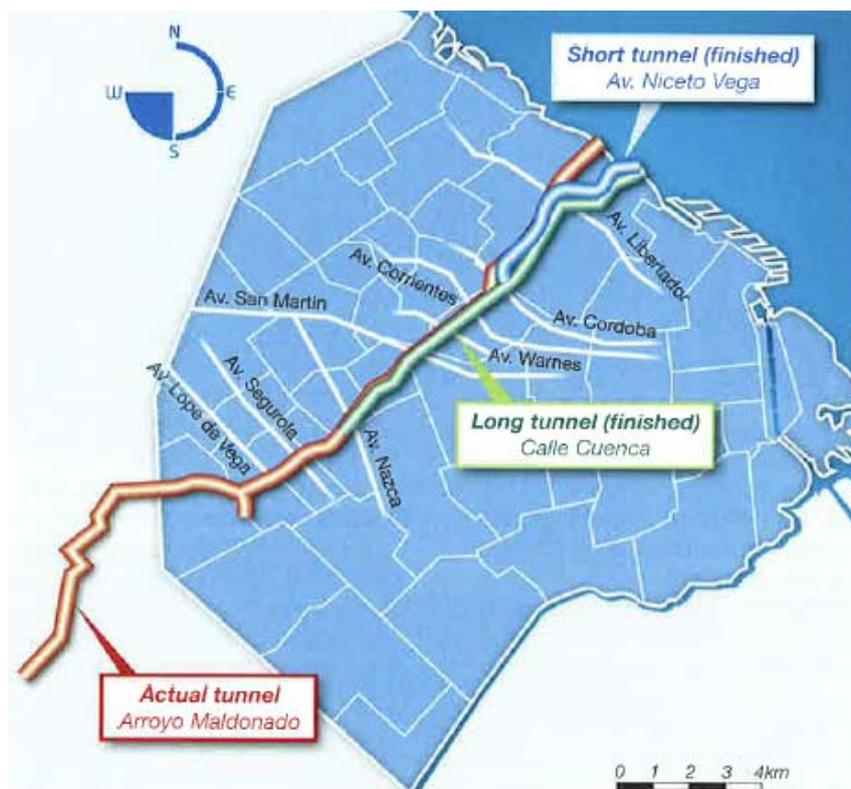
図-2 分水トンネル位置平面図
