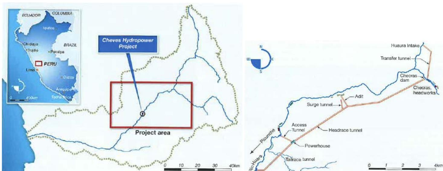
図-1 Cheves の位置および導水路、放水路トンネルの位置
