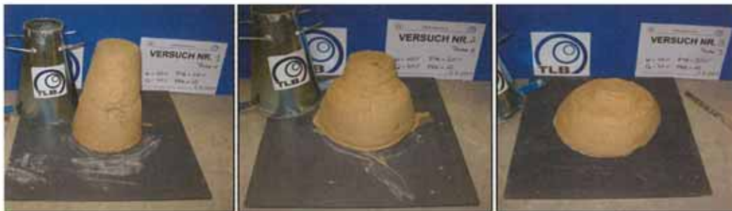
6 Setzmaßeergebnisse des Bodens B mit FIR = 10 % (1), FIR = 20 % (2) und FIR = 30 % (3) 6 Slump results of soil B with FIR = 10 % (1), FIR = 20 % (2) and FIR = 30 % (3)
