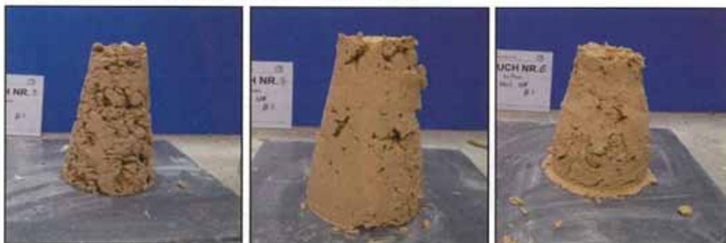
8 Setzmaßeergebnisse des Bodens C mit HDLS = 0 % und FIR = 0 % (1), HDLS = 30 % und FIR = 0 % (2), HDLS = 30 % und FIR = 30 % (3) 8 Slump results of soil C with HDLS = 0 % and FIR = 0 % (1), HDLS = 30 % and FIR = 0 % (2), HDLS = 30 % and FIR = 30 % (3)
