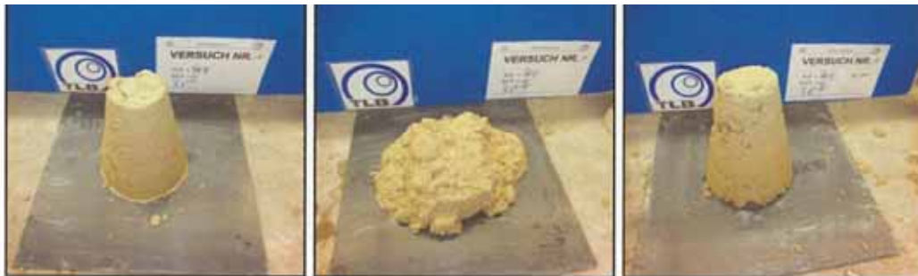
7 Setzmaßeergebnisse des Bodens C mit FIR = 50 % (1), FIR = 70 % (2), FIR = 70 % und PIR = 0,2 % (3) 7 Slump results of soil C with FIR = 50 % (1), FIR = 70 % (2), FIR = 70 % and PIR = 0,2 % (3)
