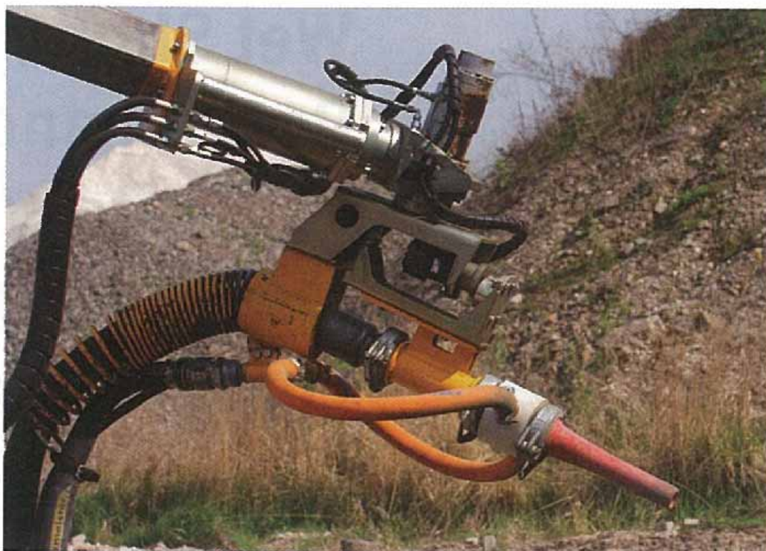
1 Düse mit Druckluft und Beschleuniger-Zugabe
