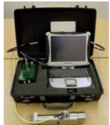
ロックボルト引張力試験機
