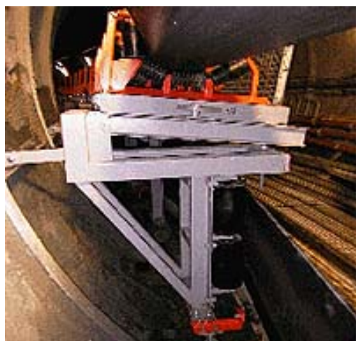
ベルトコンベアの設置台とローラー (上部をU字型に湾曲させたベルト)
