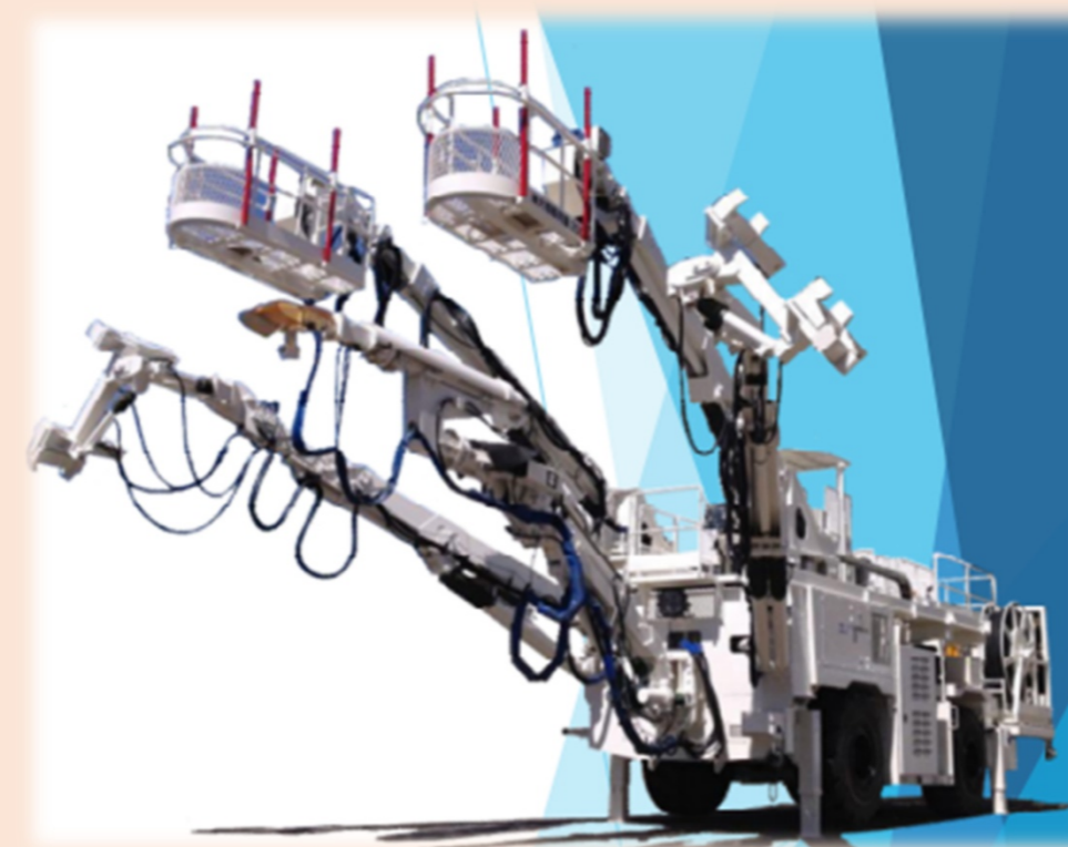
【Remote-controlled shotcrete machine】
