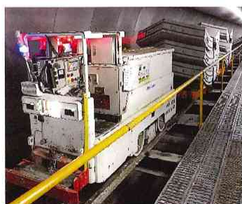
写真-1 坑内自動運行状況
