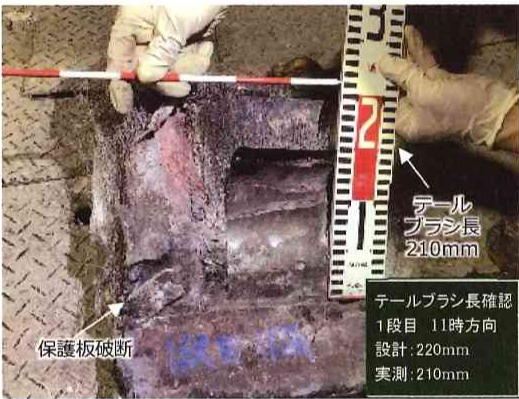
写真-4 交換したテールブラシ(1段目)
