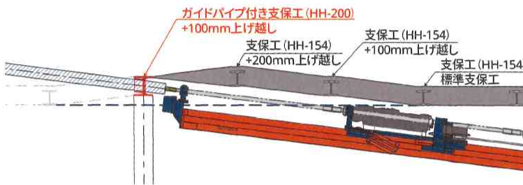
図-3 AGF-φ工法の概要
