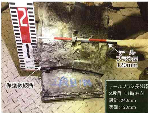
写真-5 交換したテールブラシ(2段目)
