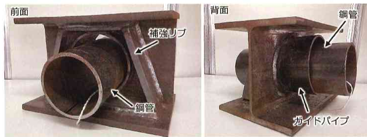
写真-2 ガイドパイプ付き鋼製支保工
