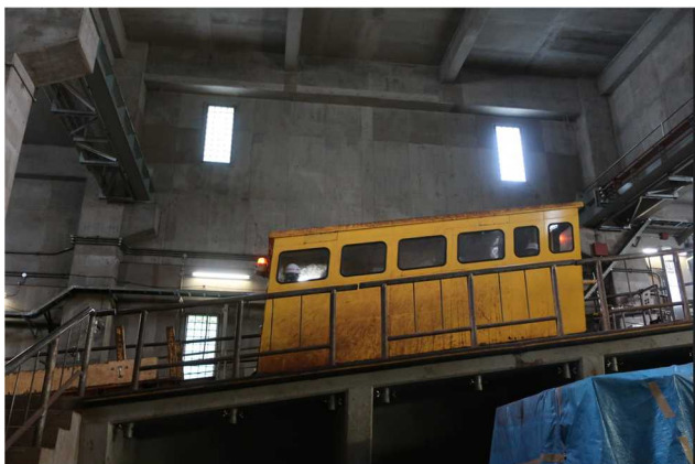
斜坑用ケーブルカー
