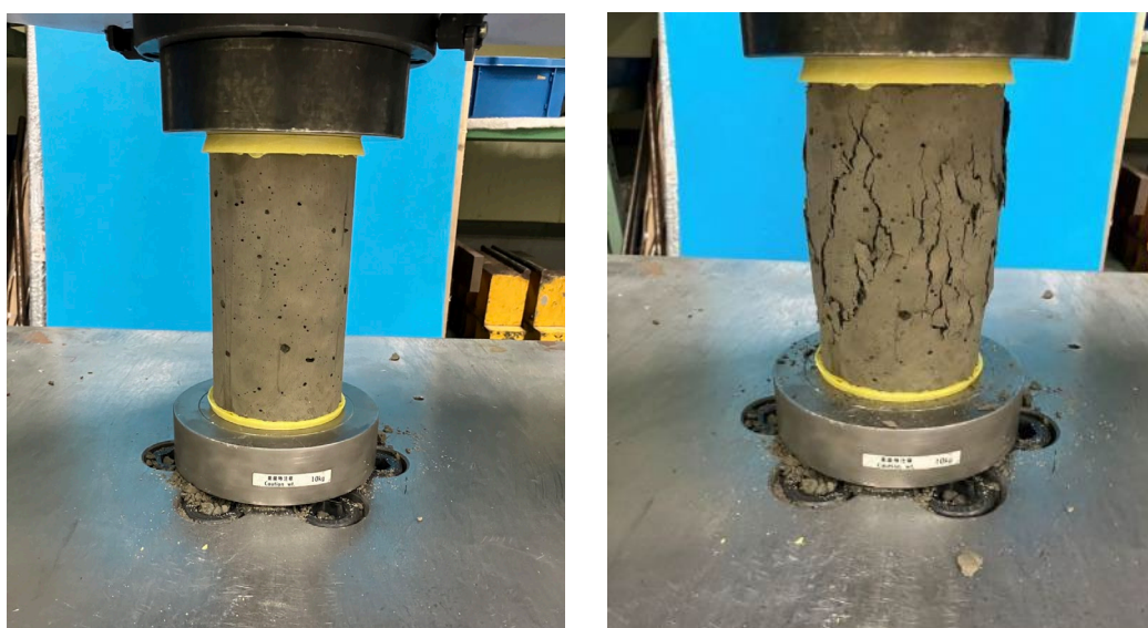
図 6 圧縮強度試験用コンクリート供試体の外観(左：荷重前，右：破壊後)
