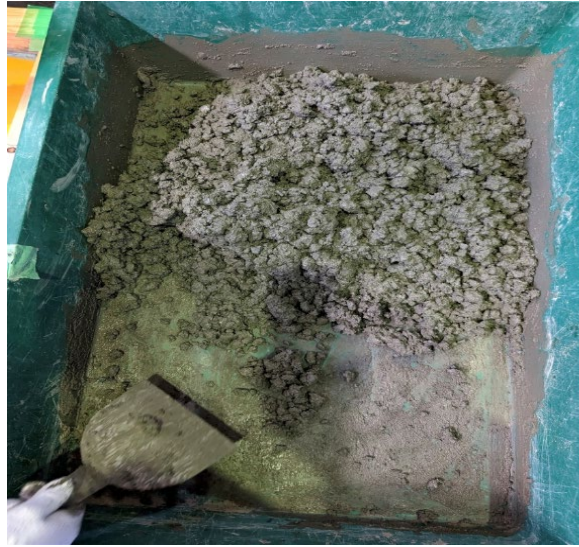
図3 コンクリート供試体作製時における練り混ぜ状況
