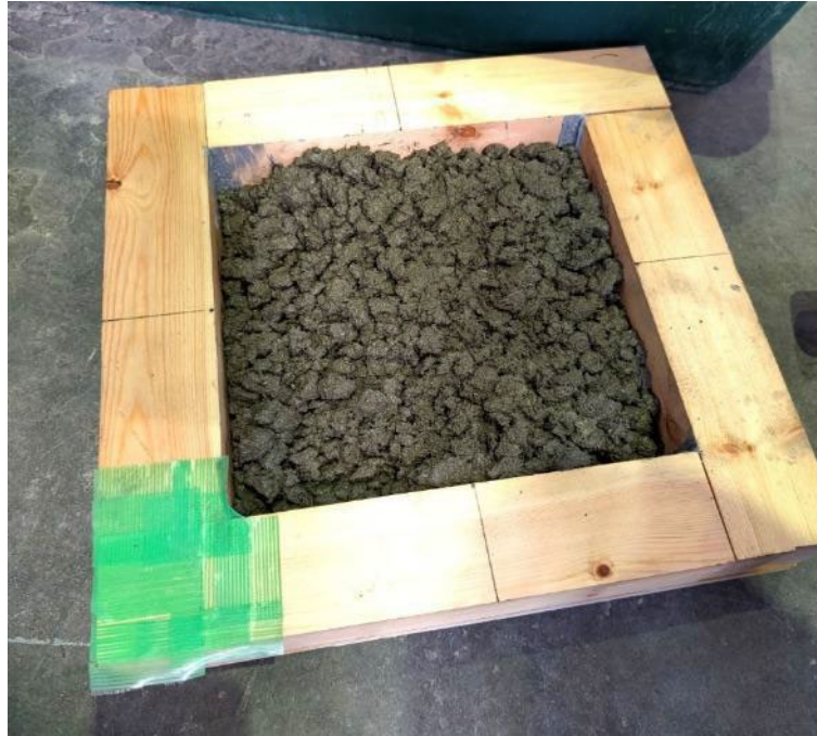
図4 木製枠に打設した直後のコンクリート供試体
