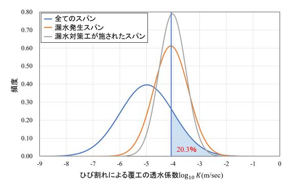
図-3.18 漏水補修工事が施された覆工スパンにおける透水係数の正規分布
