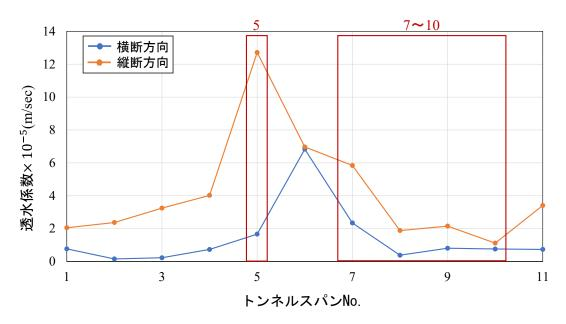
図-3.12 Bトンネルひび割れ方向成分別透水係数
