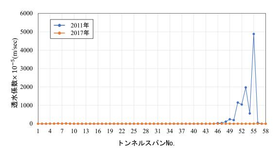
図-3.8 Cトンネルの透水係数の算出結果
