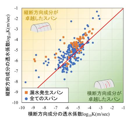
図-3.15 6トンネルのひび割れ方向成分
