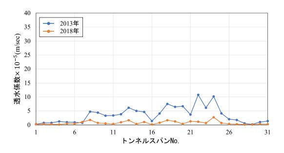
図-3.6 Aトンネルの透水係数の算出結果
