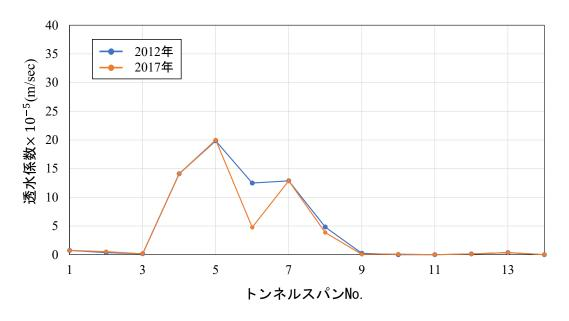
図-3.11 Fトンネルの透水係数の算出結果
