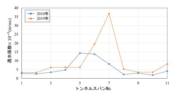
図-3.7 Bトンネルの透水係数の算出結果
