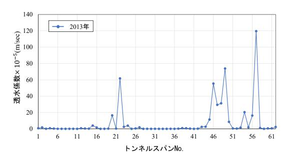
図-3.10 Eトンネルの透水係数の算出結果
