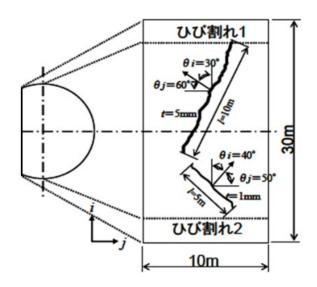
図-3.3 トンネル覆工におけるクラックテンソルの概念図
