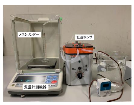
図-5.2 水の供給試験実験装置
