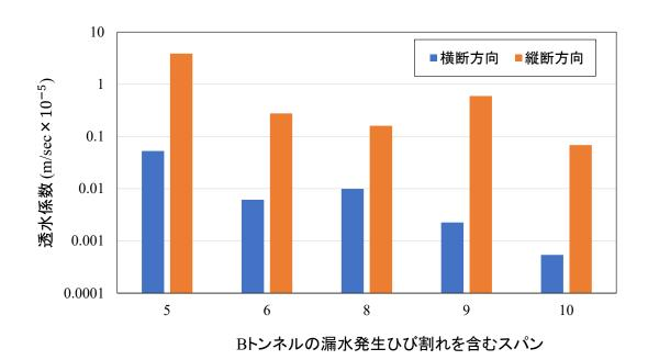
図-3.14 漏水発生ひび割れの方向成分別透水係数
