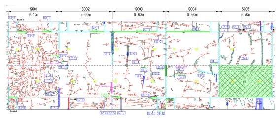
(a) F トンネルにおける 2017 年点検時の覆工変状展開図 (一部抜粋)
