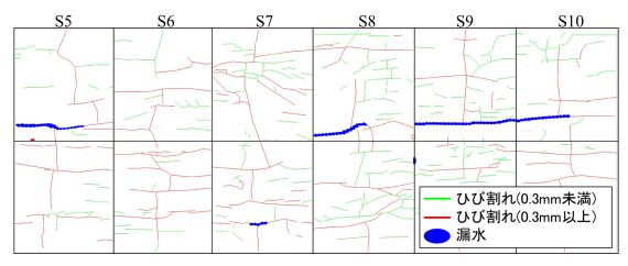
図-3.13 Bトンネル覆工変状展開図 (2010 年点検時)
