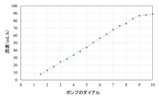
図-5.4 ポンプのダイアルと流速の関係
