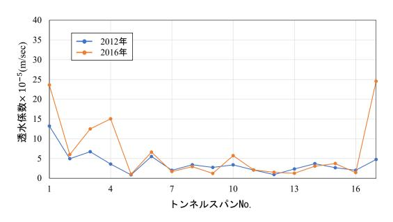
図-3.9 Dトンネルの透水係数の算出結果
