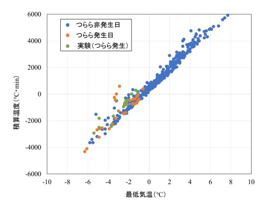
図-5.5 トンネル計測結果と実験値の比較
