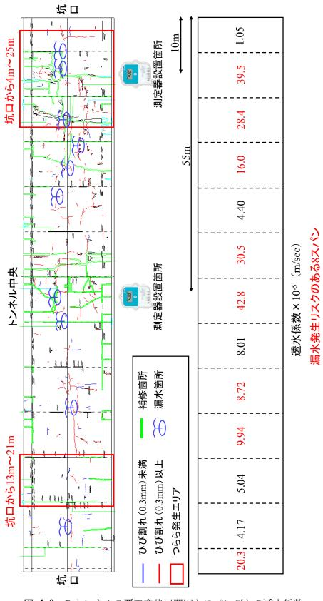
図-4.6 Gトンネルの覆工変状展開図とスパンごとの透水係数
