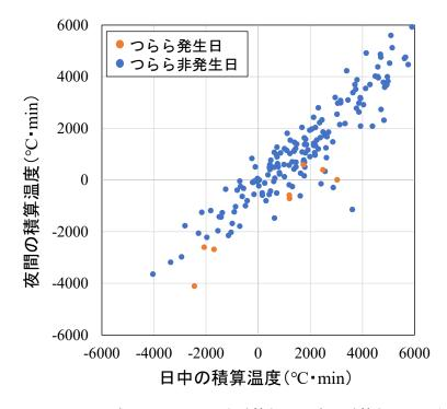
図-4.12 Hトンネルにおける日中積算気温と夜間積算気温の関係
