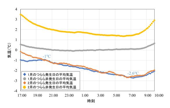
図-4.10 トンネル坑内の10分ごとの平均気温の経時変化
