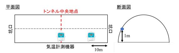
図-4.2 測定機器の設置箇所
