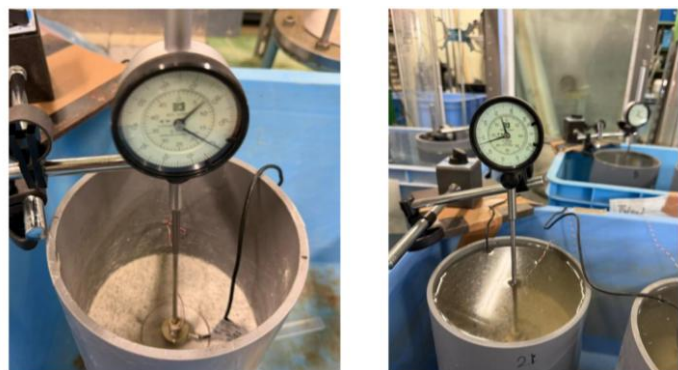
(b) 盤ぶくれ模型実験の実施状況
