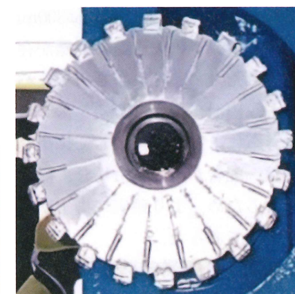
写真-2 ブレード式カッタ
