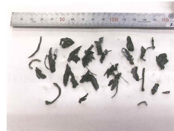
写真-6 鋼管矢板切削片
